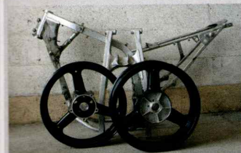
Cadre de moto sablé, jante itou, plus passage à la peinture époxy, un travail quotidien pour Yvelines sablage.
